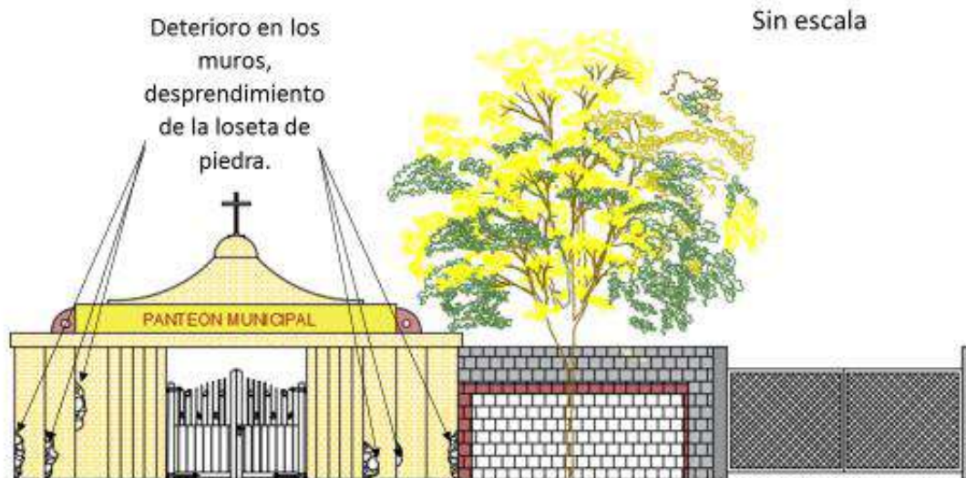
Ilustración 8. Levantamiento de deterioros del acceso principal del Panteón municipal de Jaral del Progreso. Paulina (Méndez, 2017).
